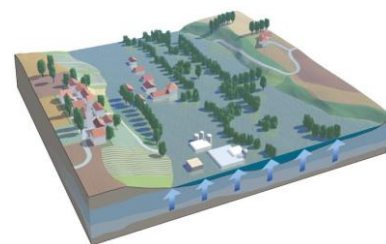
Inondation de nappe
